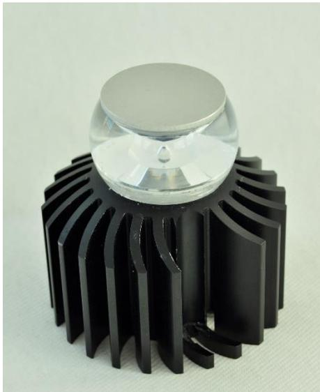
*Lampe LED de type V1.1. Diamètre de 85 mm par hauteur de 86 mm. Diamètre de la lentille 50 mm. Le capot en aluminium empêche la focalisation des rayons du soleil sur la source lumineuse.*
