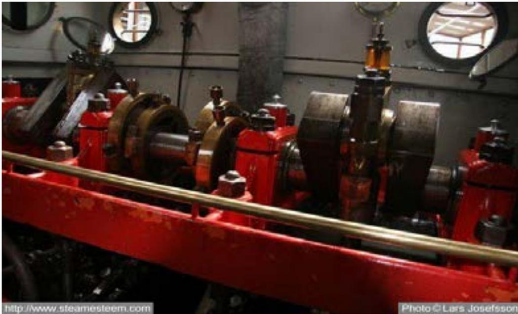
**La machine à cylindres oscillants du Hjejlen, le villebrequin est en haut les cylindres en dessous**
