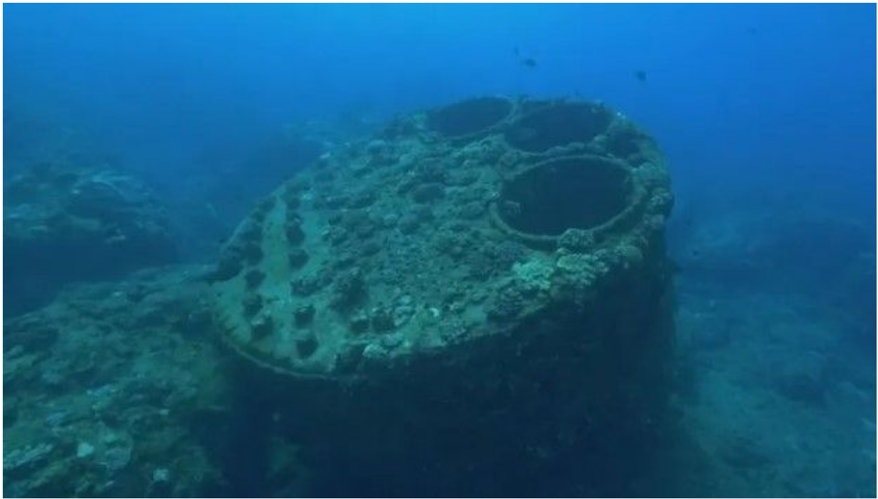
Une chaudière du Warren Hastings. Elle est du type “scotch boiler” présenté dans Sillages 59 (photo Mathieu Labeyrie)
