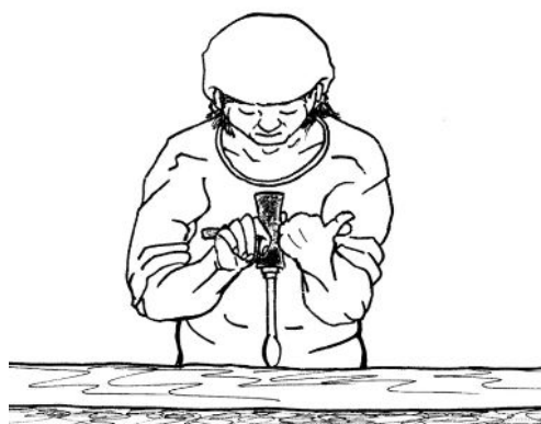
Charpentier utilisant une tarière à cuiller
