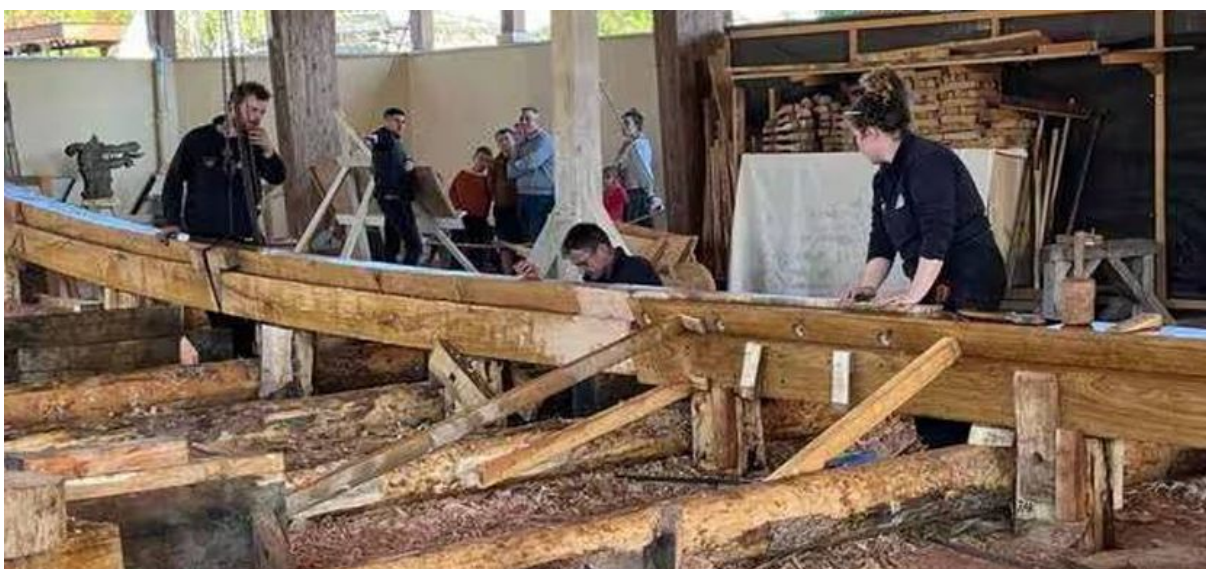
Figure 4 - « La première pièce mise en chantier est la charpente axiale. Véritable « colonne vertébrale » du bateau » (Reconstruction de La Mora au chantier naval de Honfleur. Cliché Ouest-France. Voir SILLAGES n°53)
